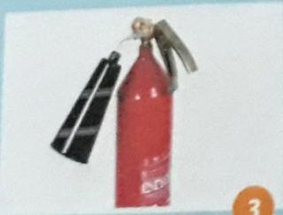
Электрический огнетушитель, которым можно тушить электроприборы. Чтобы привести его в действие, следует сорвать пломбу, выдернуть чеку, направить раструб на пламя, держа огнетушитель в строго горизонтальном положении, нажать рычаг. Находиться при этом следует не менее чем в одном метре от пламени и к раструбу не прикасаться.
